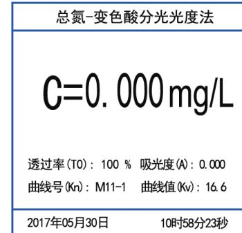
**17** 将“1”号反应管放入比色池中。屏幕显示该样品的总氮浓度。按打印键打印数据。
