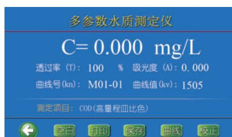
**12** 将“**1**”号比色皿放入比色池中。屏幕显示样品**COD**值。按**打印**键打印数据。
