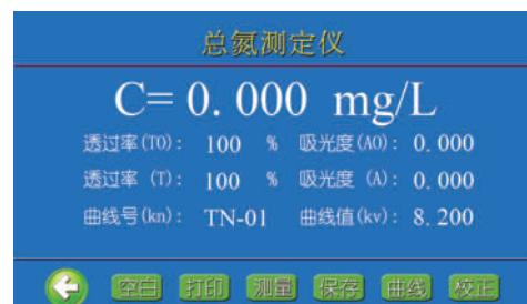
**12** 放入“1”号比色皿，按 [测量] 键，仪器执行比色操作。屏幕上所显示的结果即为 1 号样品的总氮值。
